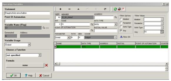
Sie sehen einen Eintrag EU xxxx in "Point of Automation" (=EMSR-Stellen nach DIN 19227). EU bedeutet E=Elektrisch, U=Antrieb von mehreren Varieblen beeinflußt. Weil der Typ-PRAP keinen Bezug zur konkreten Anlage hat, sind xxxx anstelle einer konkreten EMSR-Stelle geschrieben. Instanzen müssen dann echte Bezeichner haben.
